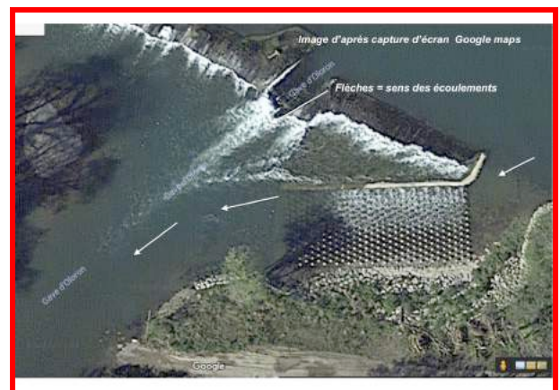
Photo N°2 : Vue de dessus de la passe à macro rugosités de Sorde l'Abbaye
